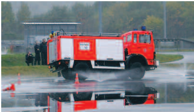
Auf der glatten Kreisbahn: Antasten an die Haftungsgrenze der Reifen.
