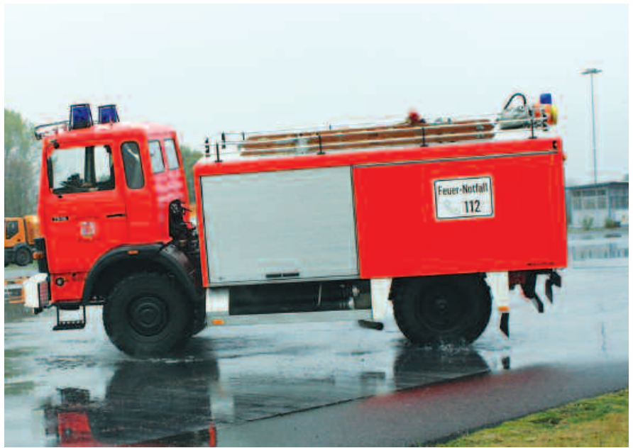
Das kleinere Tanklöschfahrzeug dreht sich bei der Vollbremsung aus der Spur (kein ABS!).
